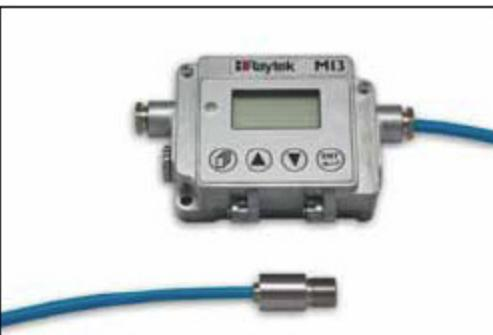
Snímací hlavice MI3 v nízkoteplotním a středněteplotním provedení LT poskytují měřicí rozsah od -40 do +600 °C, respektive od 0 do 1000 °C ve spektrálním pásmu 8 až 14 µm. Jejich použití je ve všeobecných měřicích aplikacích, zejména pak v potravinářských, plastikářských a papírenských výrobách.
